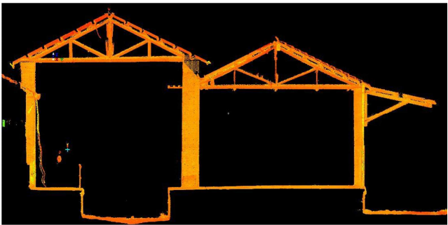
图6 屋架剖面点云数据。
