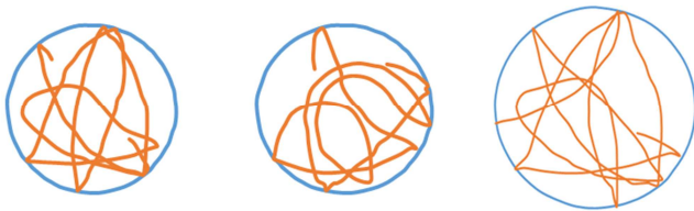
图3 6 \times 10^4 \text{N} 、 8 \times 10^4 \text{N} 和 10 \times 10^4 \text{N} 钻压下, 井深2700米处的钻柱中心运动轨迹图。
