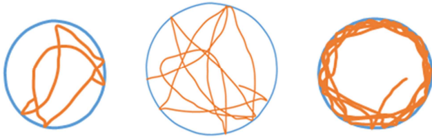
图2 30、60和90RPM转速下, 井深2700m处的钻柱中心运动轨迹图。
