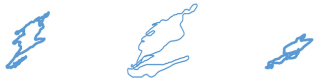
图6 30、60和90RPM转速下, 井深4900m处的钻柱中心运动轨迹图。
