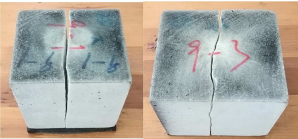
(a) 单裂纹拉裂（10mm聚四氟乙烯板）
