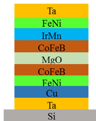
图7 TMR磁阻传感器基本结构。
