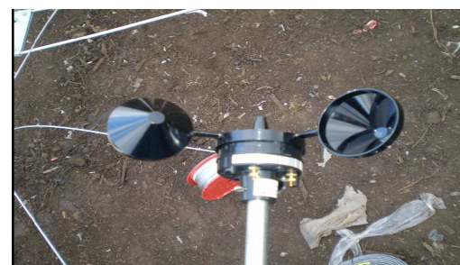
Fig. 1. Cup Anemometer
